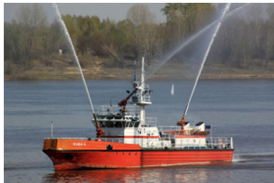
На палубе – главное средство пожаротушения корабля - стационарный лафетный ствол
