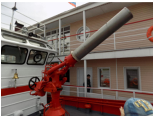
На палубе – главное средство пожаротушения корабля - стационарный лафетный ствол
